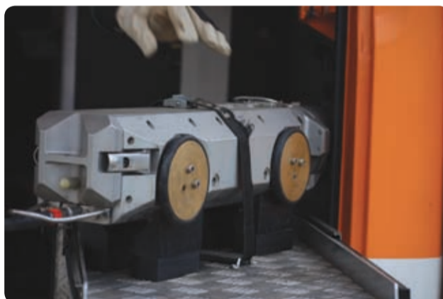
Cu ajutorul robotului Gullyver se va evalua mai ușor starea canalelor
